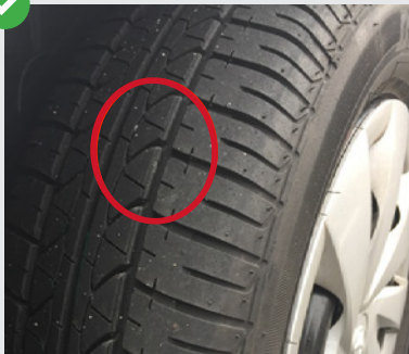
Profundidade de sulcos acima de 3mm.
