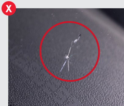
Trincas ou Área de atuação das palhetas
